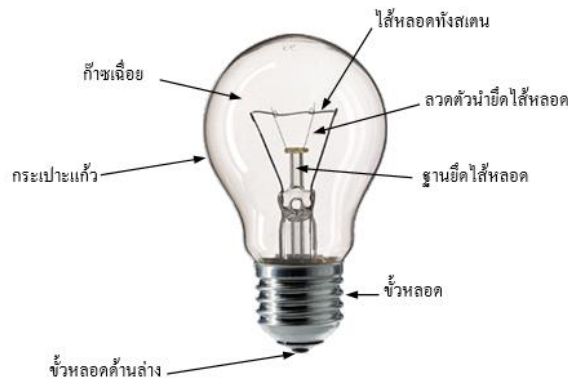
ภาพที่ 2-3 โครงสร้างโดยทั่วไปของหลอดอินแคนเดสเซนต์
