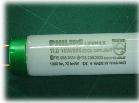
ภาพที่ 2-1 ข้อมูลลักษณะส่องสว่างที่ขั้วหลอดฟลูออเรสเซนต์สำหรับคำนวณประสิทธิภาพการส่องสว่าง
