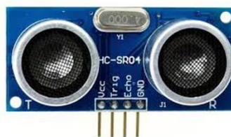
รูปที่ 2 ภาพโมดูลอัลตราโซนิกโมเดล HC-SR04
